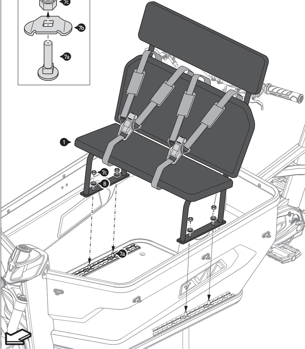
**HINWEIS:** Lassen Sie die hinteren fünf Einlässe der Airlineschiene zwecks Zugang zum Akkufach frei.
