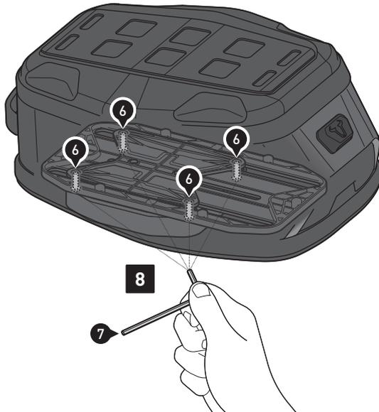
**Schritt [8]:** Ziehen Sie nach der Justierung die Schrauben (6) wie vorgegeben an.
