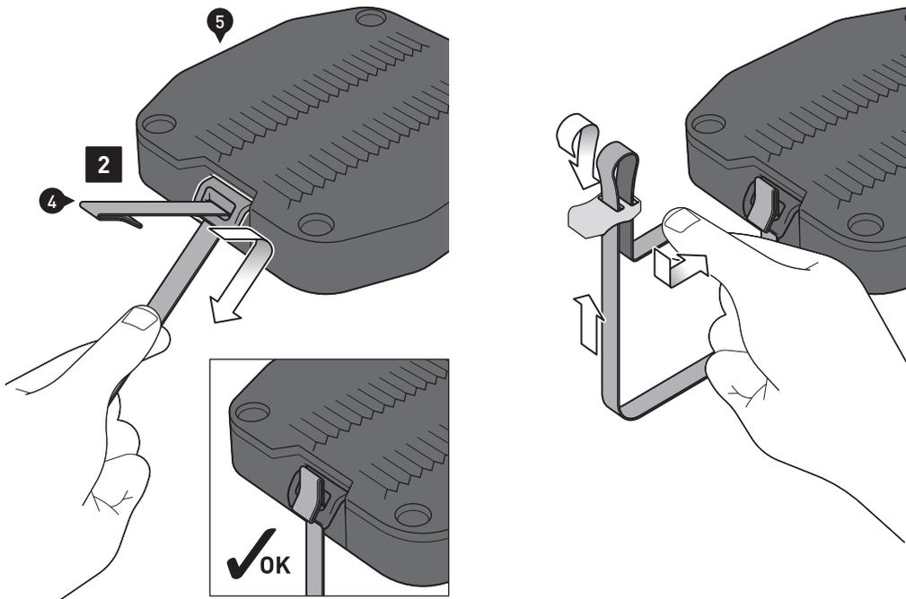
**Schritt [2]:** Führen Sie den Zugriemen (4) (liegt dem Yukon WP (8) bei) durch die Öse des Entriegelungsmechanismus des Oberrings (5).
